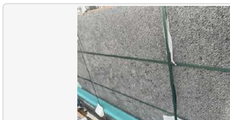
Dalle, pierre bleue Belge, surface taille ancienne mécanique, dim. 206x38cm
