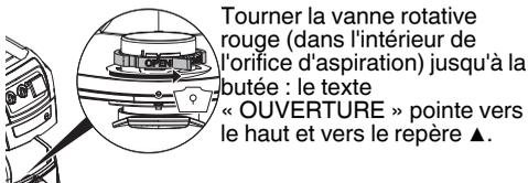
Tourner la vanne rotative rouge (dans l'intérieur de l'orifice d'aspiration) jusqu'à la butée : le texte « OUVERTURE » pointe vers le haut et vers le repère ▲.
