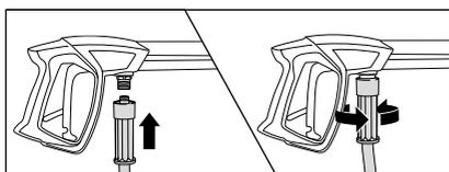
4. Brancher le raccord gris pivotant du flexible HP sur le pistolet Marche/Arrêt de sécurité, puis les visser fermement entre eux pour établir un raccordement étanche à la pression.
