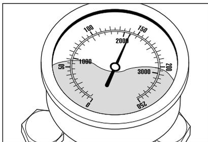
Après la fermeture Pistolet Marche/Arrêt de sécurité, le nettoyeurs haute pression doit s'arrêter et le manomètre avec boîtier inox doit alors indiquer „0“ bar. Si le nettoyeur ne s'arrête pas et que le manomètre avec boîtier inox continue à indiquer pleine pression, la cause peut être une fuite au niveau de la pompe haute pression, du pressostat, du flexible haute pression ou du Pistolet Marche/Arrêt de sécurité.
