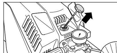
9. **Contrôler le niveau d'huile à l'aide de la jauge de niveau avant chaque mise en service.** (L'appareil doit être en position horizontale !) Le niveau d'huile doit atteindre le bord supérieur du marquage „OK“.
