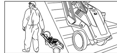
2. Déplacer le nettoyeur haute pression vers le lieu de mise en œuvre. La série K 2000 est un appareil mobile équipé de roues tout terrain très robustes permettant de franchir sans peine trottoirs et escaliers.
