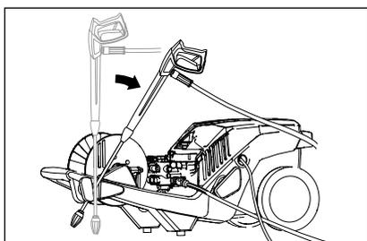
14. Les nettoyeur haute pression la série K 2000 disposent d'un logement pratique pour le rangement du pistolet Marche/Arrêt de sécurité avec lance pendant les pauses. **Par conséquent, n'utiliser le nettoyeur HP que lorsqu'il est en position horizontale.**
