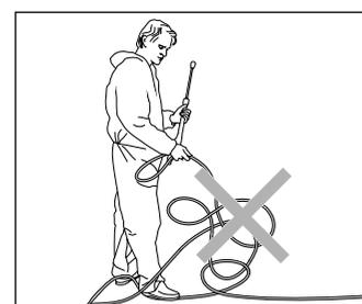
Ne pas tendre le flexible haute pression s'il y a formation de boucles ! Ne pas tirer ou laisser frotter le flexible haute pression sur une arête vive !
