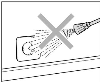
Ne pas diriger le jets haute pression sur une prise de courant ou autre dispositif électrique ! Dans le périmètre de travail, tous les dispositifs sous tension électrique doivent être étanches aux projections d'eau.
