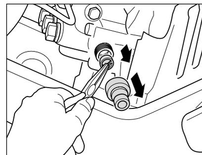
7. **Avant chaque mise en service, vérifier si le filtre d'entrée d'eau est propre.**
