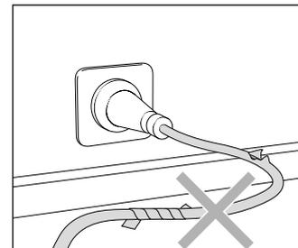
N'utiliser un cordon d'alimentation électrique que si celui-ci est en parfait état ! Ne pas endommager cordon d'alimentation électrique (le tirer violemment, l'écraser, passer dessus avec un véhicule) ou le réparer de manière inadéquate !
