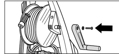
1. Sur les nettoyeurs haute pression avec tambour-enrouleur, la manivelle fournie doit être mise en place et fixée avant la première mise en service. A cet effet, mettre le nettoyeur haute pression en position verticale. Enficher la manivelle sur l'axe à six pans et la fixer en resserrant la vis fournie.
