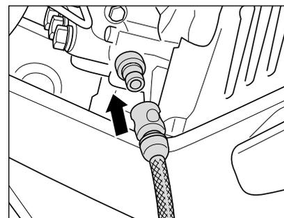
8. Raccorder le tuyau d'eau au manchon d'entrée d'eau (Exigences minimales: tuyau de 5 m de longueur, section de 3/4", 10 bars). Le nettoyeur peut être raccordé, au choix, à une conduite d'eau froide ou d'eau chaude de 60 °C max. (1 à 10 bars de pression d'alimentation). La série K 2000 permet le prélèvement d'eau d'alimentation depuis un fût (voir Aspiration directe).
