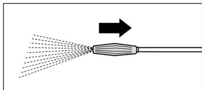
3. L'aspiration de produit additif s'interrompt automatiquement en tirant la buse Vario-Jet vers l'arrière et le nettoyeur haute pression commute en marche haute pression. Laisser agir le produit de additifs sur la surface à traiter avant de la rincer au jet de pulvérisation à haute pression.
