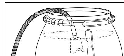
2. Accrocher le tuyau rempli d'eau au fût rempli d'eau et commencer les travaux de nettoyage. **Ne prélever que de l'eau propre ! Ne pas aspirer de l'eau contenant du chlore ! Ne pas aspirer de l'air !**
