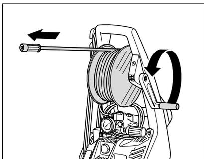
3. Sur les nettoyeurs haute pression avec tambour-enrouleur, le flexible haute pression doit être complètement déroulé. Dérouler le flexible haute pression en le tirant dans le sens perpendiculaire à l'axe de l'enrouleur et en veillant à ne pas faire de boucle. Le flexible HP peut laisser des traces de frottement sur certains sols. En alternative, vous trouverez aussi des flexibles HP Non-Marking dans notre gamme de produits.
