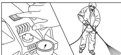
11. Mettre le nettoyeur haute pression en marche, le pistolet Marche/Arrêt de sécurité étant ouvert, puis chasser l'air du nettoyeur haute pression : A cet effet, ouvrir et fermer le pistolet à plusieurs reprises. Le nettoyeur haute pression est désormais prêt pour la réalisation des travaux de nettoyage.
