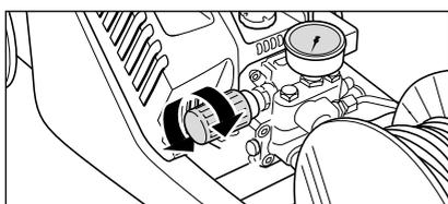
13. Régler la pression de service à la valeur souhaitée à l'aide de la poignée de réglage. La pression maximale disponible est pré-réglée en usine à une valeur fixe.
