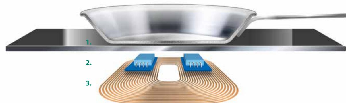
1. Plaque de cuisson      2. Capteurs      3. Bobines d'induction
