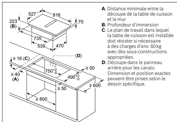
PXX875D57E D'autres schémas à partir de la page 216 Dimensions en mm
