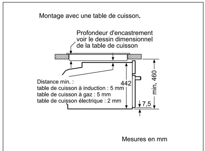
Si l'appareil compact est installé sous une table de cuisson, les épaisseurs de plaque de travail suivantes (le cas échéant y compris la sous-structure) doivent être respectées.
