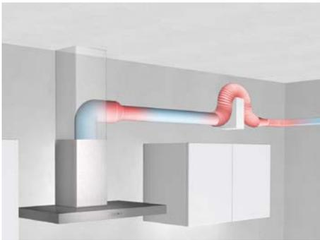
Exemple d'une mauvaise tuyauterie
