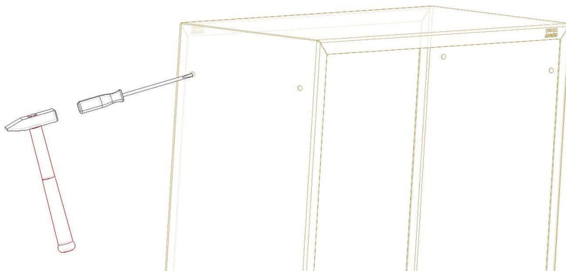
Pré-perçements pour assemblage de plusieurs range-bûches avec article 9.01.003
