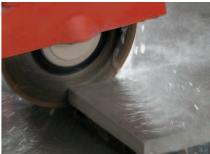
Scie sur table sous arrosage. Disque à jante continue destiné à la découpe de carrelage.
