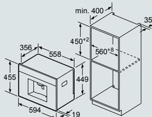
Les réservoirs d'eau et pour café en grains se retirent par l'avant. Hauteur de montage recommandée 95-145 cm.
