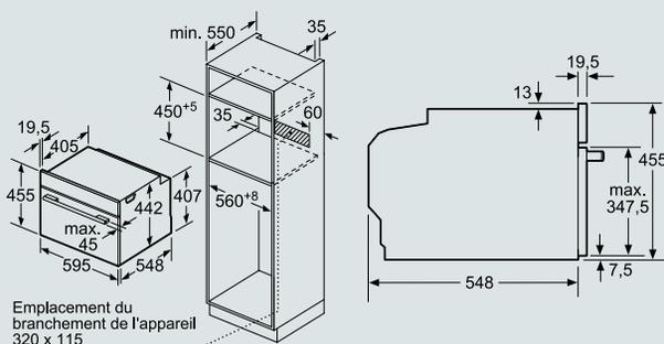
Emplacement du branchement de l'appareil 320 x 115
