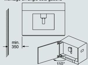
En cas d'utilisation de la limitation de charnière à 92° (réf. pièce détachée 00636455), la distance minimale au mur est uniquement de 100 mm.
