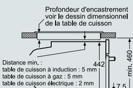
Emplacement du branchement de l'appareil 320 x 115
