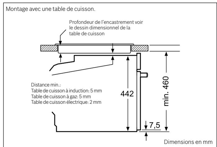
Si l'appareil est installé sous une table de cuisson, les épaisseurs de plaque de travail suivantes (le cas échéant y compris la sous-structure) doivent être respectées.
