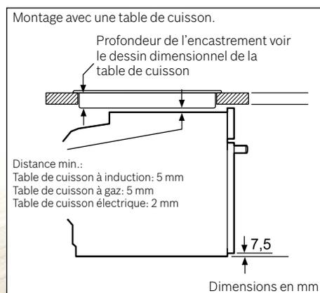
Si l'appareil est installé sous une table de cuisson, les épaisseurs de plaque de travail suivantes (le cas échéant y compris la sous-structure) doivent être respectées.
