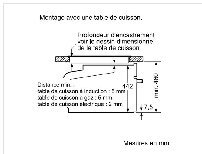
Si l'appareil compact est installé sous une table de cuisson, les épaisseurs de plaque de travail suivantes (le cas échéant y compris la sous-structure) doivent être respectées.
