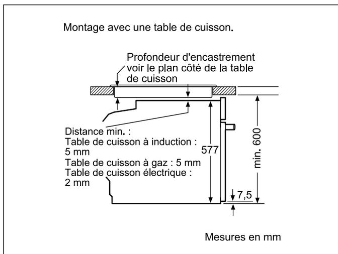
Si l'appareil est installé sous une table de cuisson, les épaisseurs de plaque de travail suivantes (le cas échéant y compris la sous-structure) doivent être respectées.
