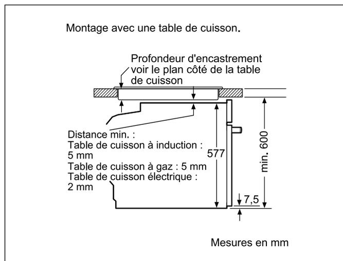
Si l'appareil est installé sous une table de cuisson, les épaisseurs de plaque de travail suivantes (le cas échéant y compris la sous-structure) doivent être respectées.
