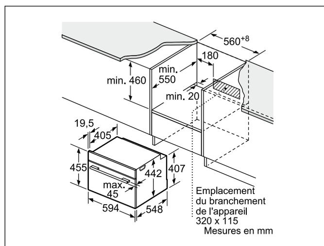
Pour les appareils avec micro-ondes, ventilation dans le socle min. 50 cm<sup>2</sup>.
