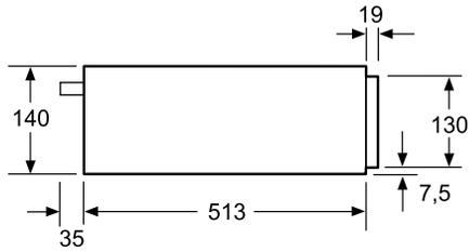
Les fours compacts d'une hauteur d'appareil de 455 mm peuvent être installés au-dessus d'un tiroir chauffant. Une set de montage n'est pas nécessaire.
