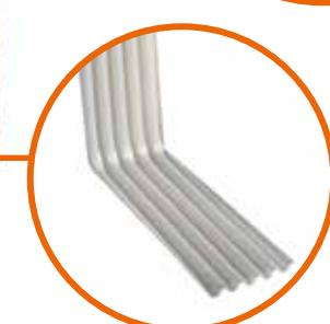
**Dryvent:** produit en plastique recyclé, à profil ondulé de 10 mm, avec des microfissures pour permettre la ventilation horizontale et verticale. Pré accouplé avec une membrane en polyester qui transpire mais imperméable. Il est léger et facilement pliable pour tout type de support.
