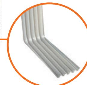
**Dryvent:** prodotto in materiale plastico riciclato, a profilo grecato passo 10 mm, con microfessure per consentire la ventilazione orizzontale e verticale. Preaccoppiato con una membrana in poliestere traspirante ma idrorepellente. È leggero e facilmente curvabile per qualsiasi tipo di supporto.
