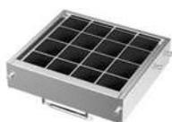
Ce filtre à charbon innovant présente une grande efficacité d'absorption des odeurs et une résistance mécanique élevée. Il peut être nettoyé tous les 3 à 6 mois par régénération thermique en le plaçant au four pendant 60 minutes à 200 °C.
